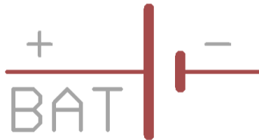
Schaltungszeichen einer Batterie / Batteriezelle
